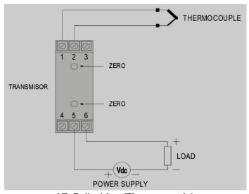
ATxRail wiring (Thermocouple)
